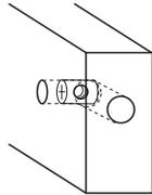
ジョイントコネクターのナットを入れる時は穴の向きを木口の穴の方向に合わせる。
