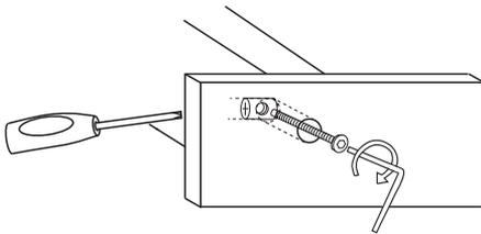
ボルトが入らない場合はジョイントコネクターをドライバーでまわして調整する。
