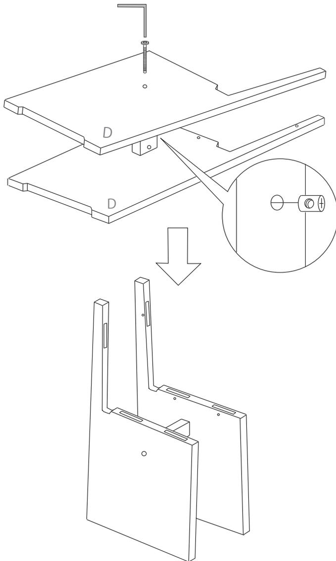
8 A (座面) を六角レンチで4箇所締めて取り付ける
