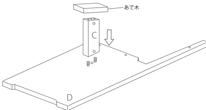
3 Cを取り付けたらジョイントコネクタを埋め込む
