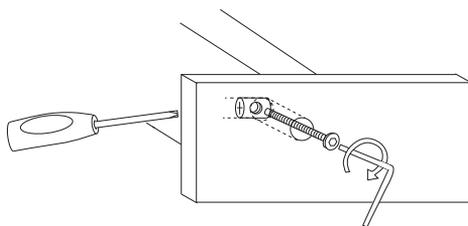
ボルトが入らない場合はジョイントコネクタのナットをドライバーでまわして調整する。
