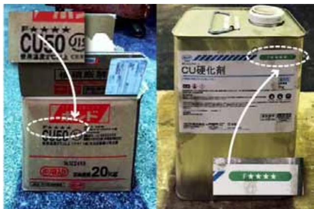
右：水性接着剤用硬化剤(ポリイソシアネート)速乾性の接着剤、下地に使用 左：水性高分子-イソシアネート系木材接着剤(無垢材のハギ加工時に使用)
